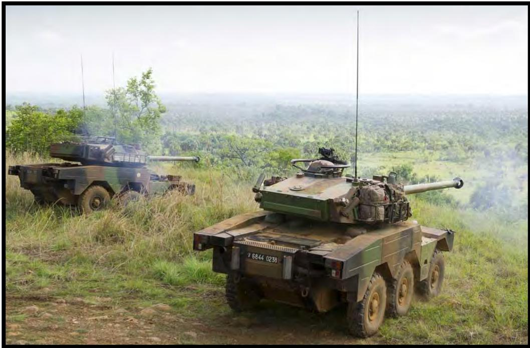
**Engin blindé léger à 6 roues motrices (6x6) équipé d'un canon de 90mm**
